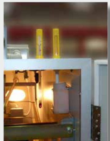
Kit termometro-igrometro lettura analogica temperatura e umidità.
